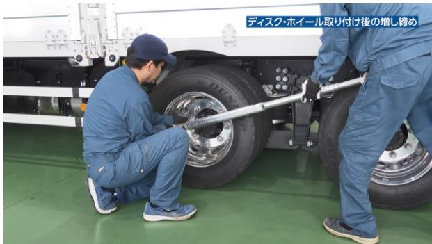
タイヤ脱着後、50km～100km 走行後を目安に、ホイール・ナットを既定のトルクで再度締め付けます。
