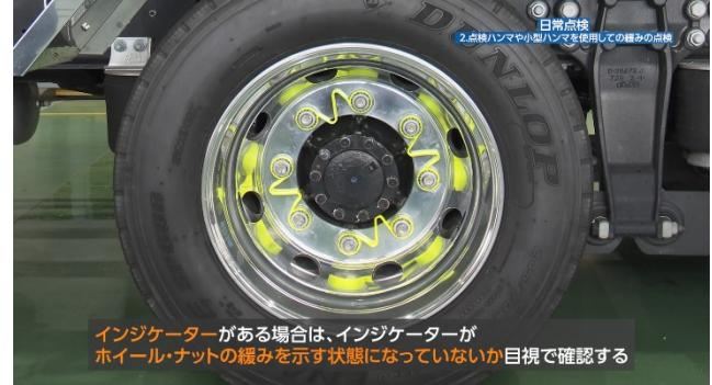
ホイール・ナットに緩みがないか、マークリング、インジケーターによる目視確認か、点検ハンマーによる確認を行います。
